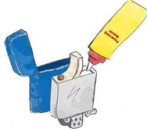
Zum Einfüllen des Benzins muss der Einsatz (Benzintank) aus der Metallhülle herausgezogen werden. Ist dies geschehen, hält man den Benzintank in den Händen. Auf der Unterseite befindet sich eine Filzabdeckung. Diese Abdeckung muss angehoben werden, damit die darunterliegende Watte mit Benzin aufgefüllt werden kann. Tränke die Watte bis sie vollgesogen **aber nicht triefend nass ist**.
